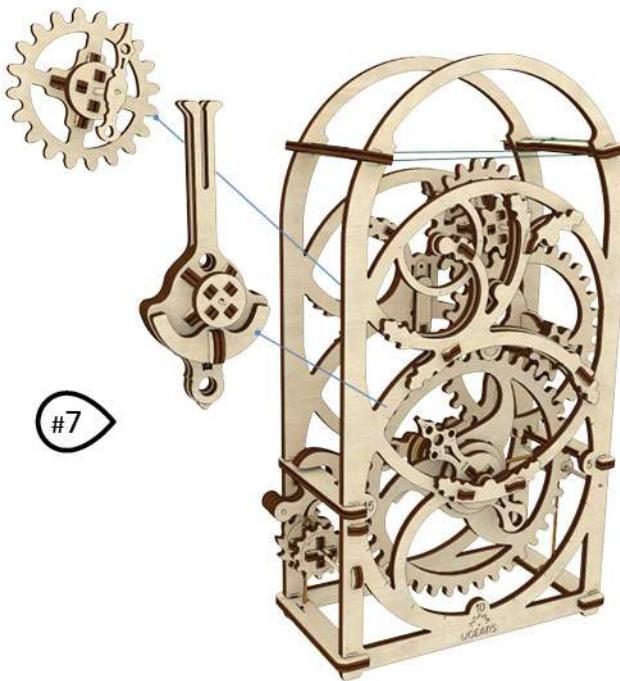
**RO** Daca rola pendulului continua sa functioneze haotic dupa ce ati pus in aplicare pasii de rezolvare a problemelor: Luati pendulul din timer, inlaturati toate cele trei axe din pendul si inlocuiti-le cu cele noi. Asigurati-v-a ca axele noi sunt drepte si ca toate partile sunt aliniate corespunzator. Folositi ceara solida de lumanare pentru a unge axele pendulului. (figura 7)
