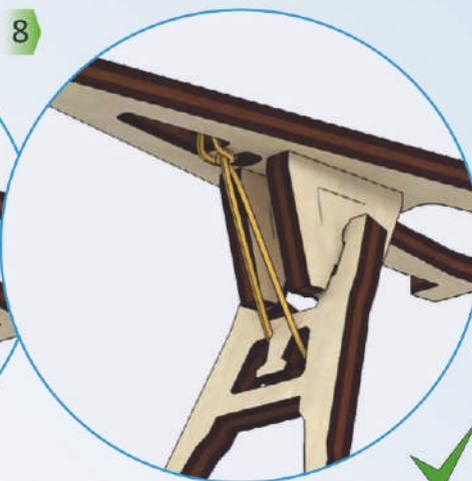
ENG The band should be tight. UKR Гумка повинна бути натягнута. DEU Das Gummi muss gespannt sein. FRA L'élastique doit être serré. POL Gumka powinna być napięta. SPA El elástico debe ser ajustado. ITA L'elastico deve essere teso a sufficienza. TUR Lastik gerilmiş olmalıdır. RUS Резинка должна быть натянута. KOR 고무밴드의 장력은 팽팽해야 합니다. CHI 橡皮筋必須拉緊
